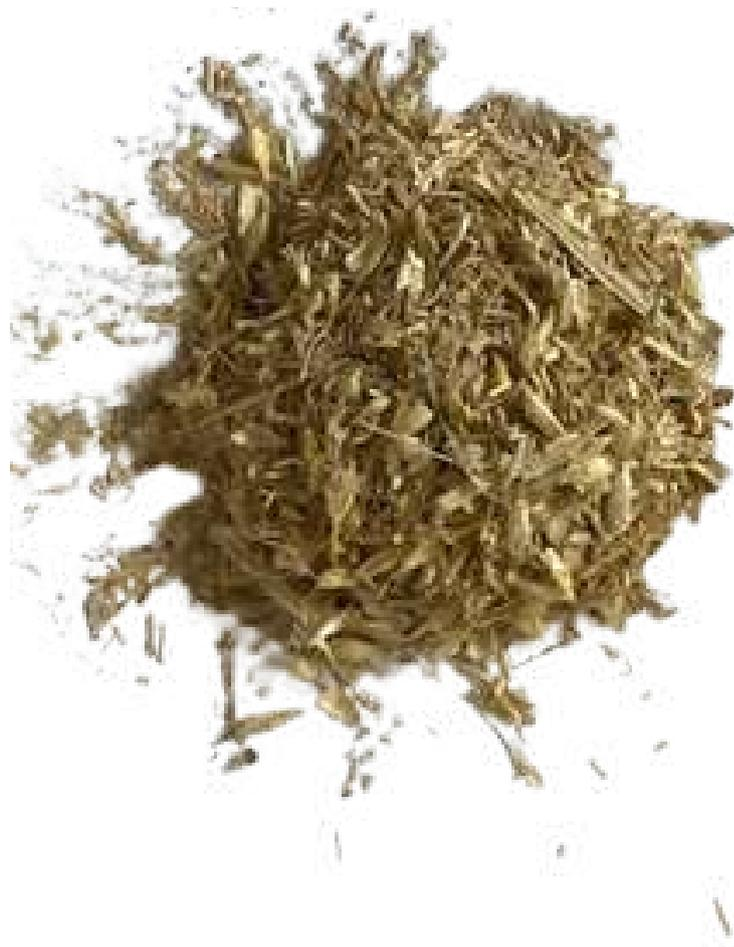
Questo trattamento offre i vantaggi di poter essere gestito direttamente nei siti di produzione degli scarti e di essere tecnicamente semplice ed efficace. Gli scarti agricoli forniti per il progetto RICREA sono stati sminuzzati attraverso l'utilizzo di un mulino industriale con un setaccio con maglie da 40 mesh (Figure 1 e 2).
