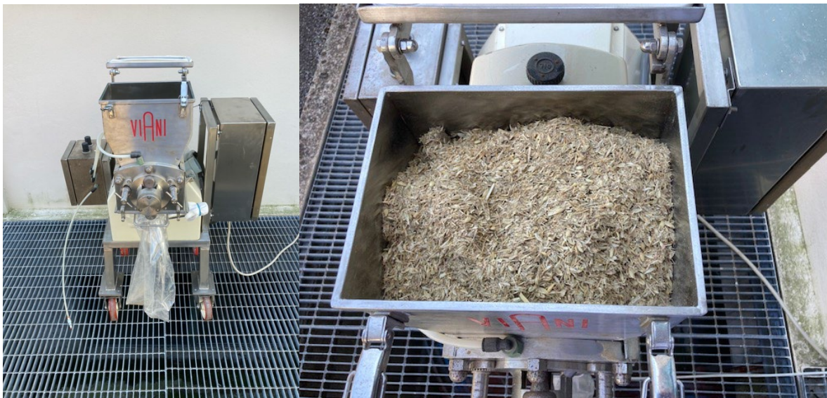
Figura 1. Mulino utilizzato nella sminuzzatura degli scarti cerealicoli
