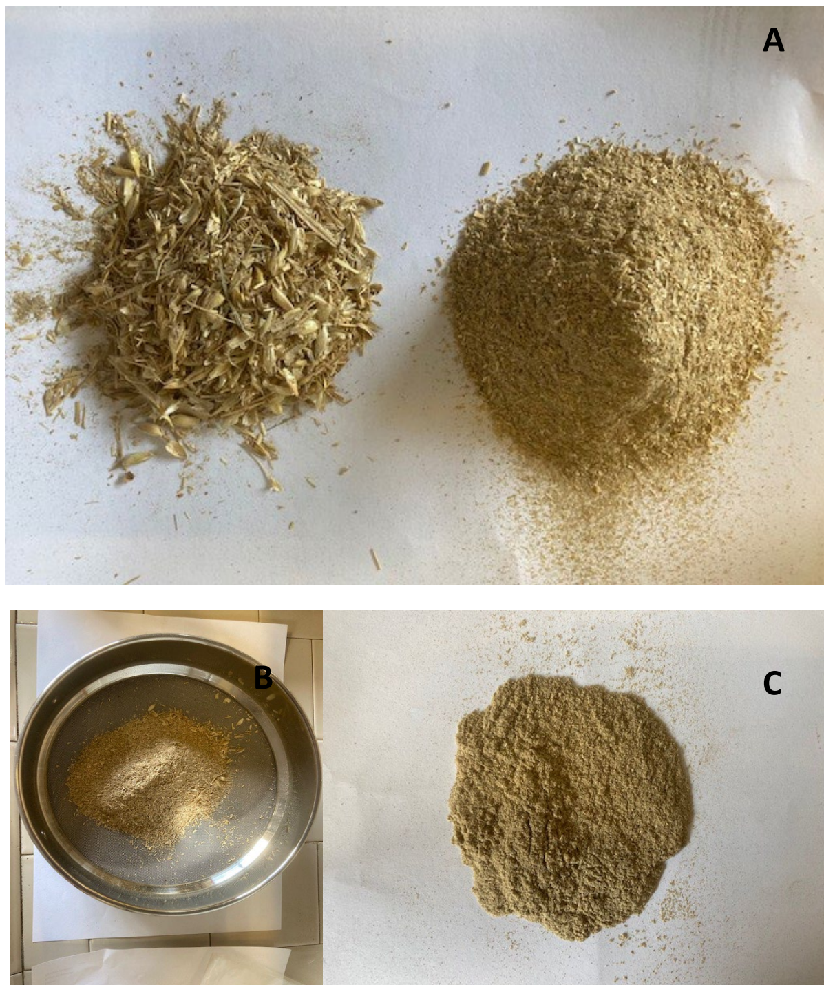
Figura 2. Scarti cerealicoli nelle diverse fasi di trattamento. A) sminuzzatura, B) setacciatura, C) materiale pronto all'uso.
